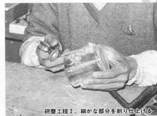
研磨工程2 細かな部分を削り仕上げる
