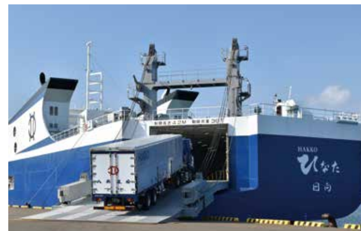
大型化した新造船は、荷台(シャーシ)71台、乗用車100台を積載可能
