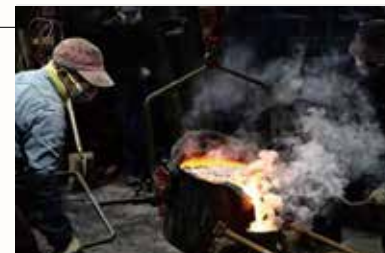
1200℃以上で溶かして鋳型に流し込む
